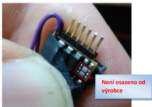
Obr.1 dekodér bez funkčního výstupu FA1/FA2 výrobce pravděpodobně šetřil náklady a neosadil součástky v červeném rámečku
